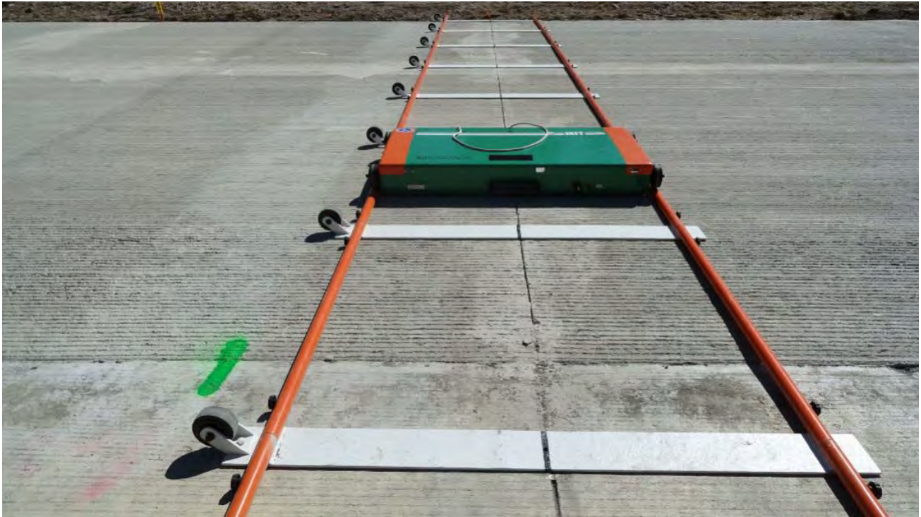
Figure 2.14 MIT device in use [20]
